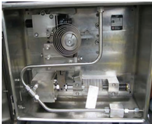
Mechanismus der BPIV-Knickstab-Druckentlastungs-Armatur (geschlossene Position)
